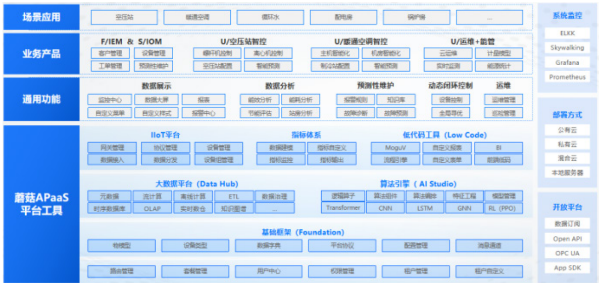
图 蘑菇云通用设备工业互联网平台架构
